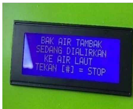
Gambar 3.5 Tampilan LCD 20x4 Saat Tombol 1 Ditekan
