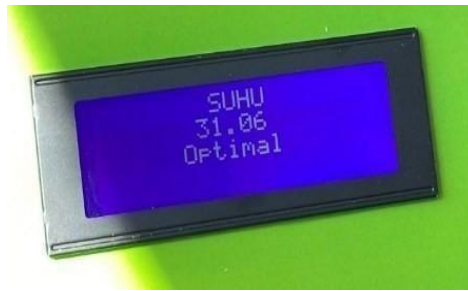
Gambar 3.10 LCD 20x4 Menampilkan Nilai Suhu Pada Tambak Udang
