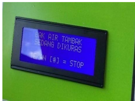
Gambar 3.7 Tampilan LCD 20x4 Saat Tombol 3 Ditekan
