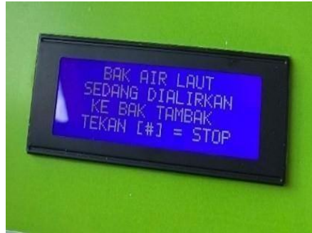
Gambar 3.6 Tampilan LCD 20x4 Saat Tombol 2 Ditekan
