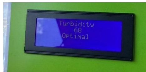
Gambar 3.11 LCD 20x4 Menampilkan Nilai Turbidity Pada Tambak Udang
