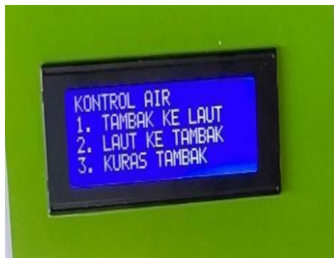
Gambar 3.4 Tampilan LCD 20x4 Setelah (*) Ditekan
