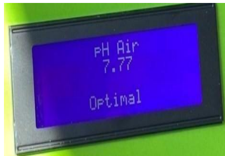
Gambar 3.8 LCD 20x4 Menampilkan Nilai pH Tambak Udang
